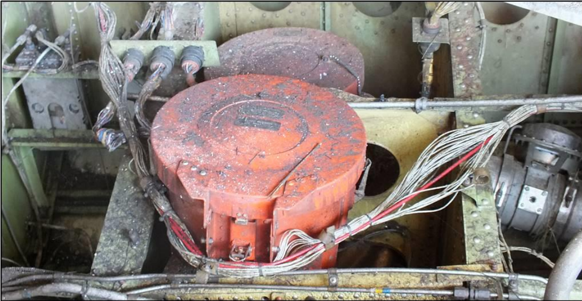
Fotografía No. 4: Condición de los registradores de vuelo entre los restos de la aeronave
