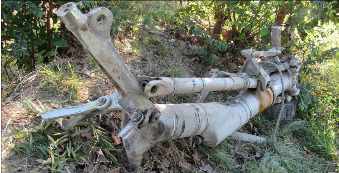
Fotografía No. 11: Estructura del Tren de aterrizaje principal derecho
