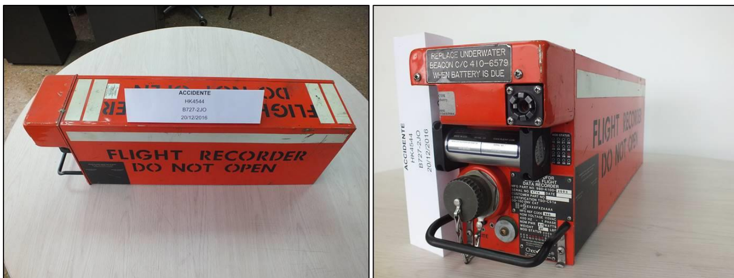
Fotografía No 14: Registrador de Datos de Vuelo FDR, S/N 4714
