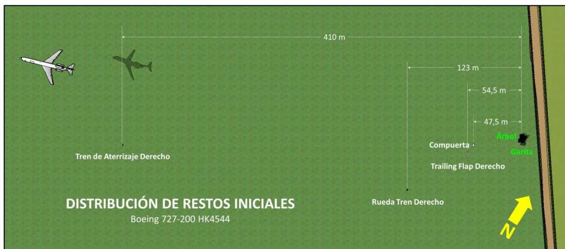
Gráfica No. 3: Diagrama de distribución de restos tras la colisión inicial
