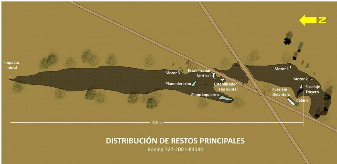
Gráfica No. 4: Diagrama de distribución de restos principales
