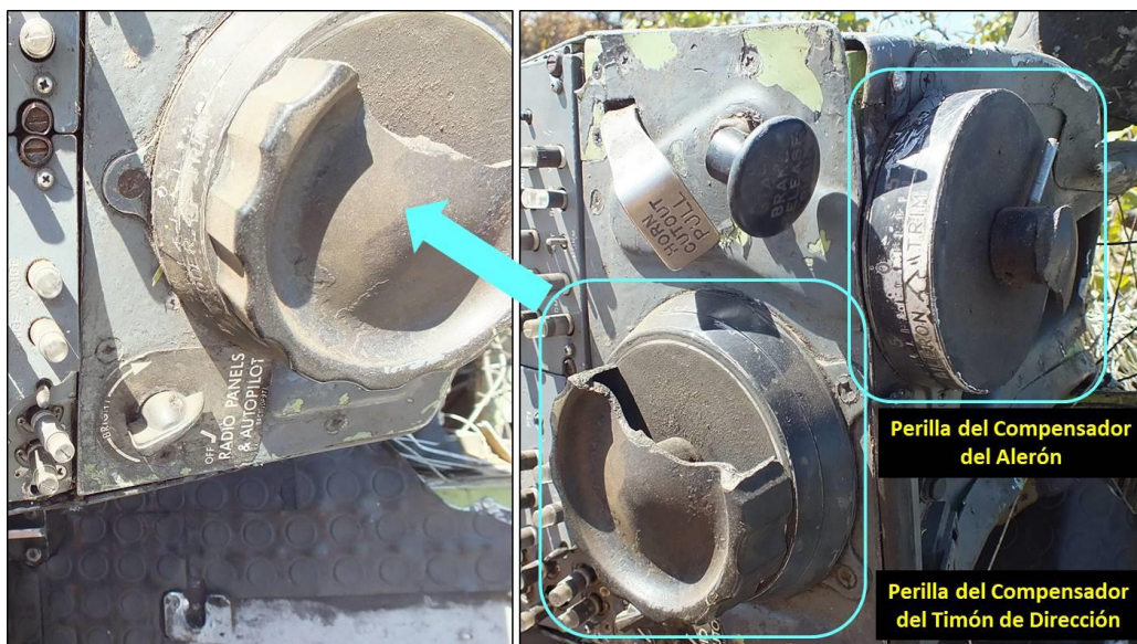
Fotografía No. 9: Posiciones de las perillas compensadoras de alerones y timón de dirección
